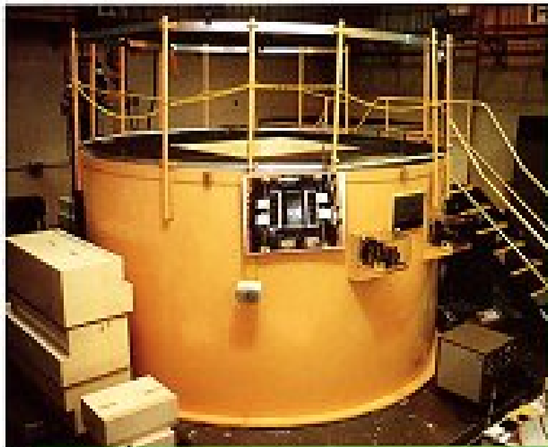
UTR-KINKI(生体遮蔽タンク)の外観
